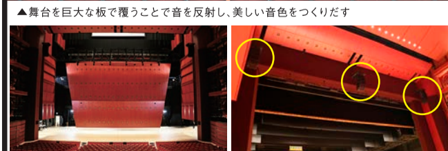
▲普段は天井に吊り下げて収納しており、設置には約1時間かかる
