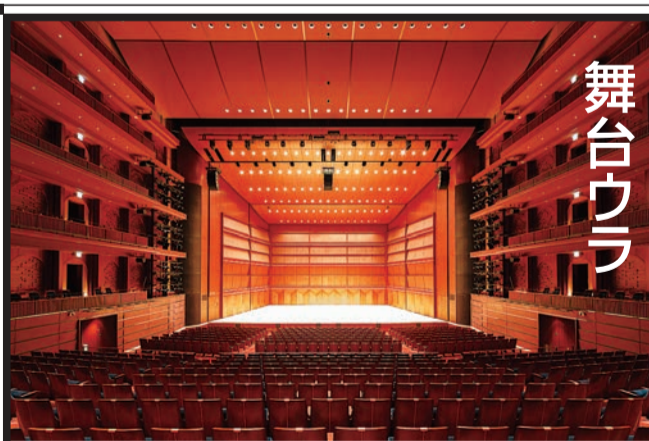
▲舞台を巨大な板で覆うことで音を反射し、美しい音色をつくりだす
